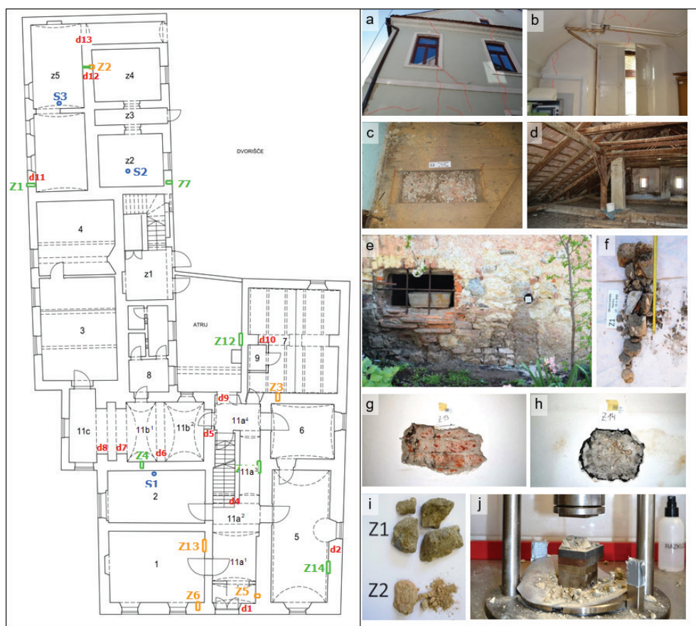
Slika 8. Tloris pritličja glavne in zadnje stavbe sodišča v Sevnici z lokacijami preglednih mest (levo), pregled poškodb (a, b), pregled stropa in strehe (c, d), globinsko sondiranje v kamnitem zidovu (e, f), površinsko sondiranje (g, h), odvzeti kosi malte (i) in laboratorijski preskus vzorca malte (j).
