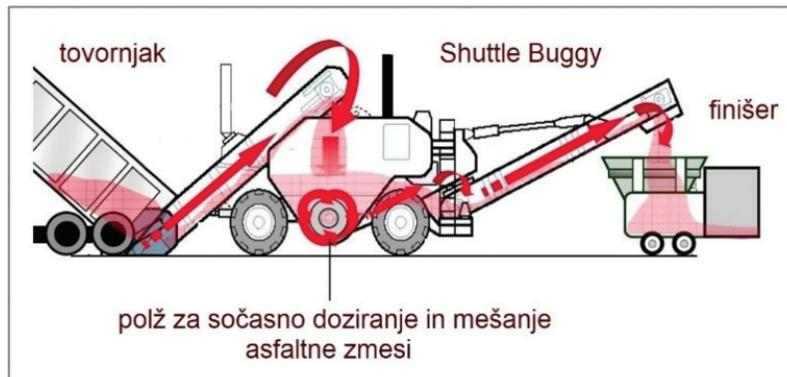
**Slika 14.** Podajalnik shuttle buggy [Rošer, 2020].
