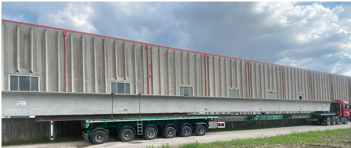
Slika 3. Prednapeti »wing« nosilec in kompozicija za izredni prevoz.
