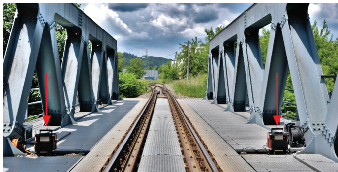
Slika 5. Lokaciji vzbujevalnikov za meritev dinamičnega odziva.
