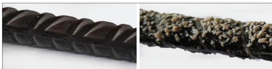
Slika 3 • Primerjava videza površine jeklene rebroste armature (levo) in armature iz bazaltnih vlaken s spiralnim ovojem in peščenim posipom (desno).
