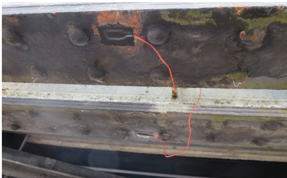
Slika 16 • Zaščiteni merilni lističi za meritev napetosti na spodnji strani spodnjega pasu.
