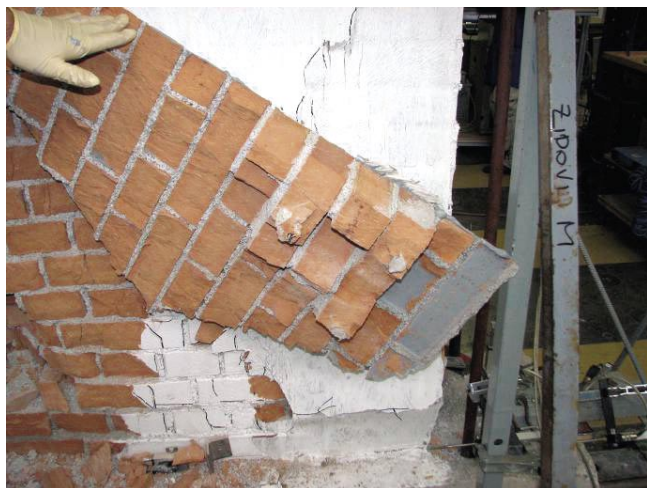
Slika 19 • Detalj odlučene obloge z GFRP-kanino v epoksidni matriki po končani preiskavi (utrđitev tipa 9)
