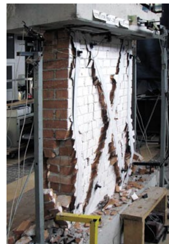
Slika 21 • Zid, utrđjen s CFRP-trakovi (utrđitev tipa 11), pred porušitvijo
