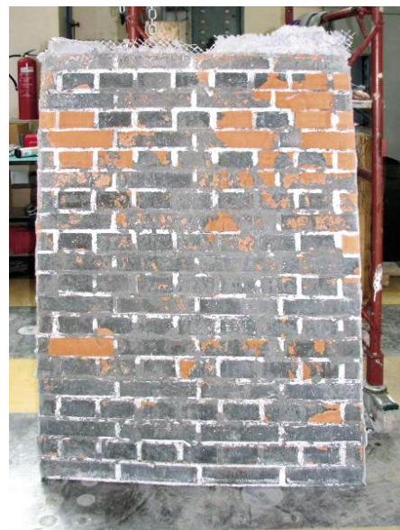
Slika 13 • Diagonalno položena GFRP-mreža v cementni malti (utrditev tipa 13): odstranjena obloga po končani preiskavi zidu
