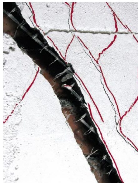
Slika 18 • Detalj pretrganja niti diagonalno položene GFRP-mreže (utrditev tipa 7)
