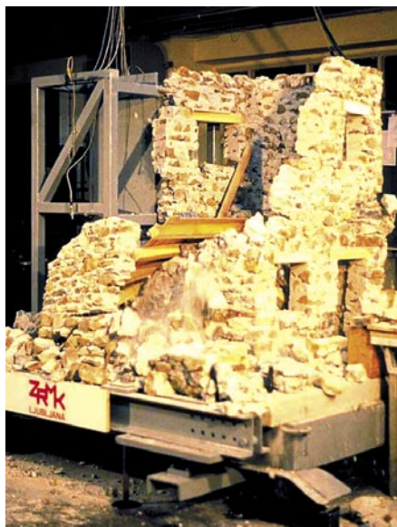
Slika 22 • Mehanizem porušitve modela kamnite hiše z nepovezanim zidovjem
