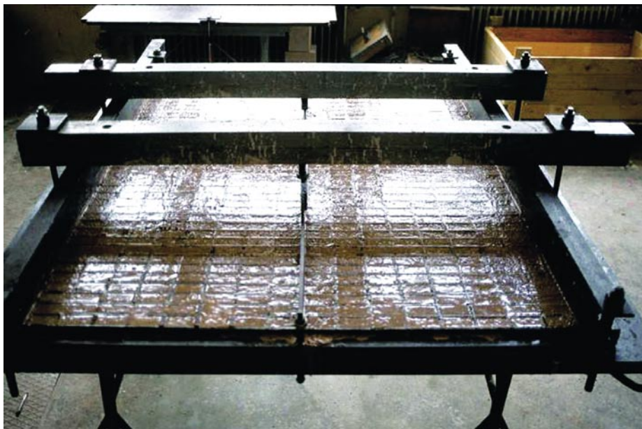
Slika 4 • Izdelava modelnih zidakov z jeklenim opažem
