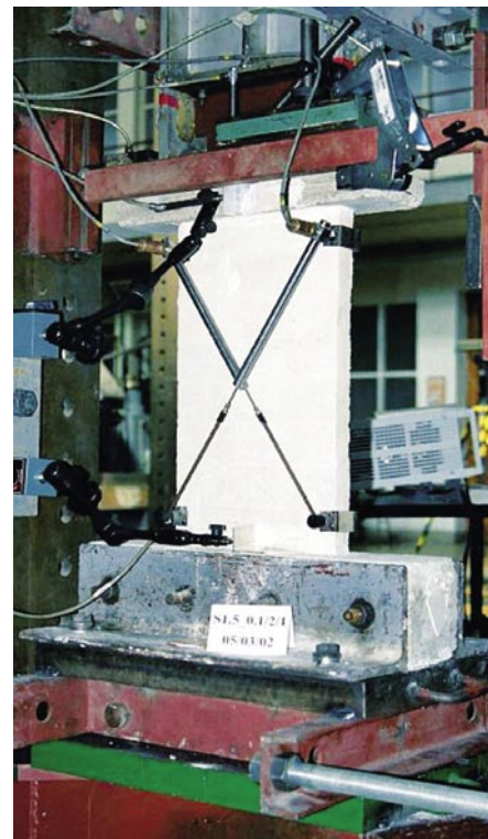
Slika 5 • Preiskava modelnega zidu v posebej zasnovani napravi
