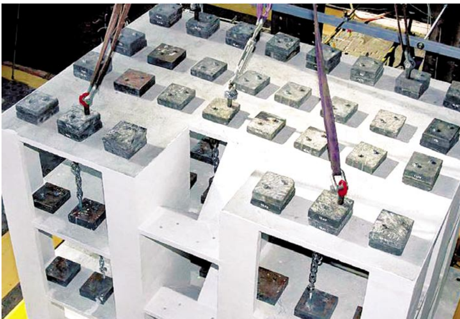
Slika 9 • Koristno obtežbo predstavljajo jekleni bloki, ki so z vijaki pritrjeni na stropne plošče modela
