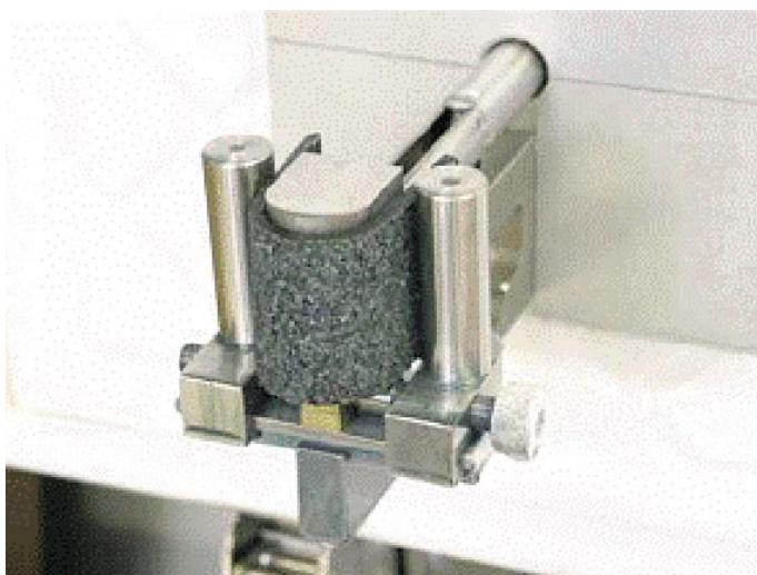
Slika 1 • Določevanje upogljivosti bitumenskih trakov pri nizkih temperaturah
