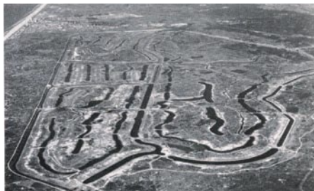
Slika 12 • Primer sonaravnega bogatenja podtalnice na dinah (dunes) za vodovod v Amsterdamu
