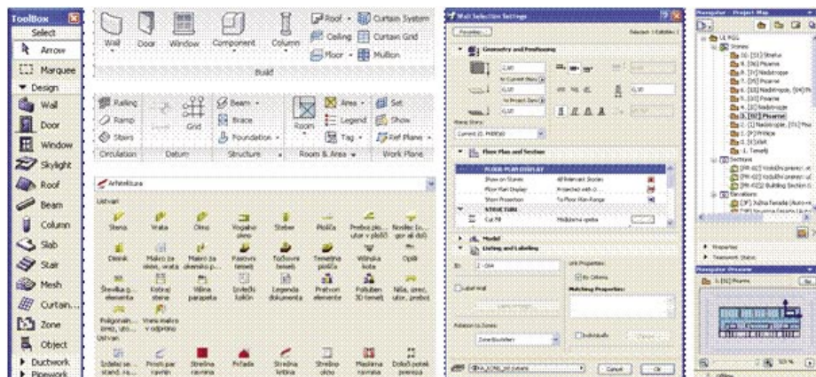
Slika 1 • Standardni elementi/deli stavb v modelirnikih BIM: ArchiCAD (1. stolpec skrajno levo), Revit (2. stolpec zgoraj), Allplan (2. stolpec spodaj). Pri modeliranju lahko elementom, na primer steni pripišemo parametre (3. stolpec). Nabor standardnih elementov različnih modelirnikov je podoben (temelji, stene, stebri, grede, plošče, stopnice, okna, vrata, streha), inženirski modelirniki omogočajo tudi modeliranje detajlov, stikov, armature ter povezavo s programi za račun konstrukcij. Elemente stavbe običajno konstruiramo v 2D po etažah, ki so določene z hierarhično fizično strukturo (desno).
