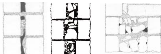
Slika 2 • Razvrstitev prerezov dvo- in trislojnih zidov (Binda in sod., 2001)
