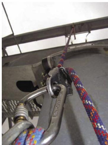
Slika 7 • Nepravilnost – uporaba enojne linije vrvi
