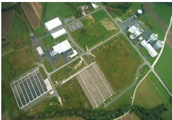
Slika 22 • Po potrjenem projektu zgrajena č. n. brez denitrifikacije efluenta in z negospodarnim sušenjem blata.
