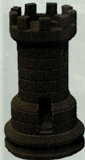
Slika 14 • Izdelek z vidno površinsko hrapavostjo in povečava njegove površine z vidnimi sprijetimi delci materiala
