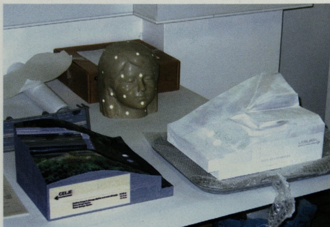
Slika 34 • Utrjen levi in neutrjen (svetel) desni del modela terena
