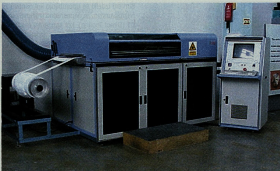
Slika 16 • Stroj LOM-2030H firme Helisys, Inc. (ZDA), z laserjem moči 50 W. Naredi lahko model do velikosti 813 x 559 x 508 mm
