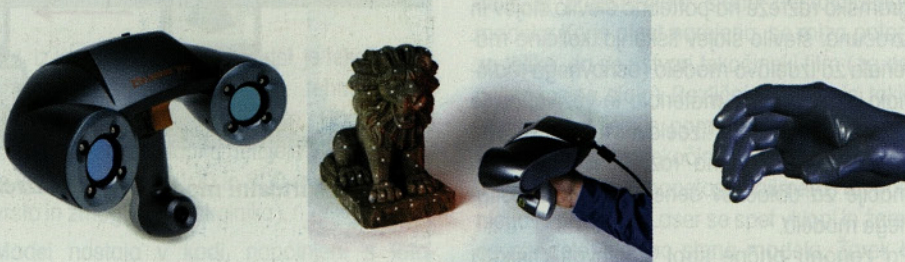
Slika 6 • 3D digitalizator ZScanner 700 firme Z Corporation Systems (ZDA), skeniranje kipca z nalepljenimi reflektivnimi točkami in skenirana roka
