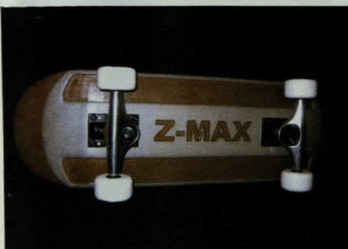
Slika 28 • Izdelana deska rolke s privitimi kolesi in preizkušanje njene trdnosti ter uporabnosti
