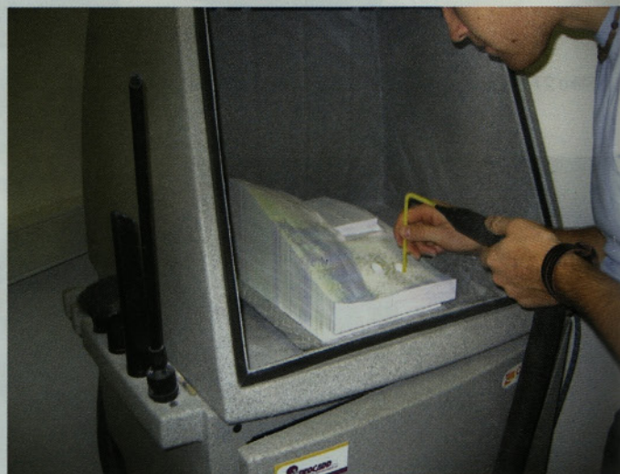
Slika 32 • Odstranitev prahu iz modela v čistilni komori
