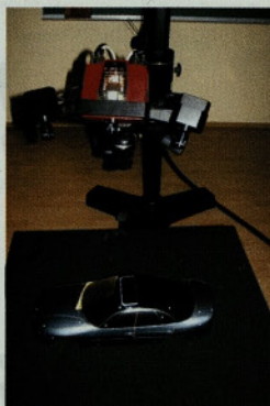
Slika 7 • Digitalizator Atos II pri snemanju modela avtomobila z nalepljenimi reflektivnimi točkami, zajete točke objekta (oblak točk) in vektorji pomikov izmerjenih točk statično obremenjenih vrat avtomobila
