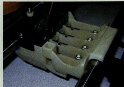
Slika 5 • Originalen nosilec tiskalnih glav 3D tiskalnika firme Z Corporation (črne barve) in prototip (svetle barve) po utrditvi, vrtanju odprtin za puše in njihovi vstavitvi ter vgrajen prototip
