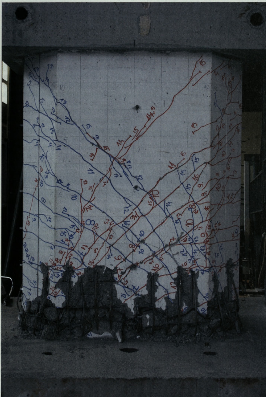
Slika 9 • Kratek steber po zaključenem eksperimentu (Bevc, 2006b)
