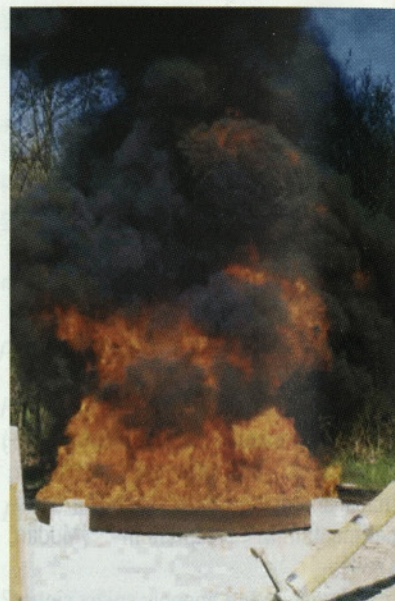
Slika 8: Plamensko telo požarnega testa v ponvi premera 300 cm
