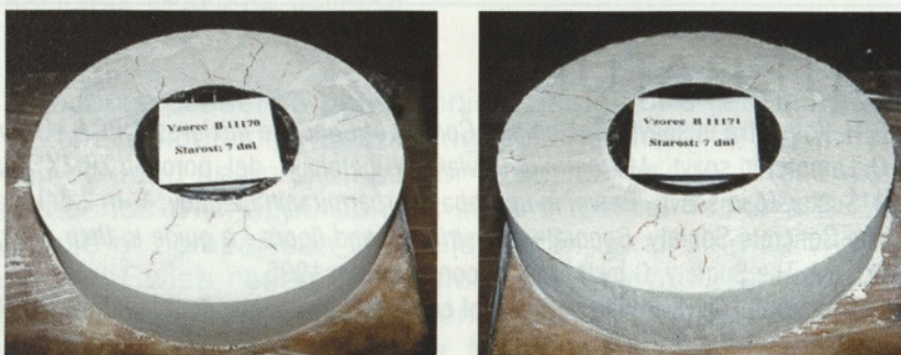
Slika 12: Opazovanje razvoja plastičnega krčenja: a) referenčni (nearmirani) in b) s polipropilenskimi vlakni ojačeni beton – posnetek razpok na betonu po 7 dnevih sušenja (s črno barvo so označene razpoke po 4, z rdečo barvo pa razpoke, nastale med 4. in 7. dnevom sušenja)
