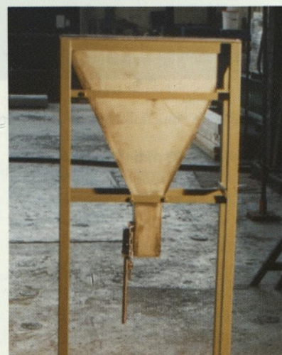
Slika 6: V-lijak za preiskavo viskoznosti samozgoščevalnega betona v laboratoriju FGG.
