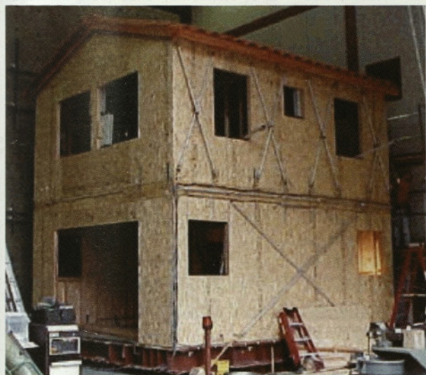
Slika 1: Preiskava dvonadstropnega lesenega objekta v naravni velikosti na potresni mizi v raziskovalnem laboratoriju Charles Lee Powell v San Diegu aprila 2000.
