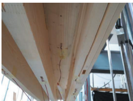
Slika 7 • Fotografije razpok (Zisi, 2016): v robnem rebri (levo), v srednjem rebri (sredina), v robnem rebri ob porušitvi plošče (desno)
