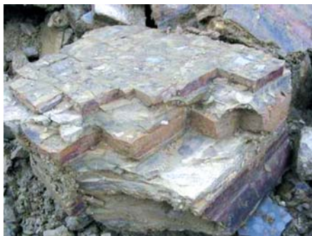
Slika 15 • Volumski razpad fliša na ČHE Avče
