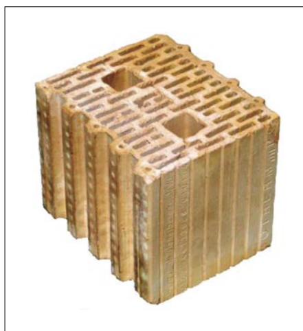
Slika 4 • Opečni votlak A, s katerim so bili sezidani preizkusni zidovi serije A: h/l = 0,7
