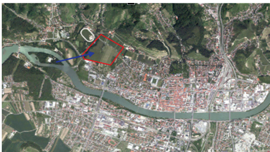
Slika 12 • Območje vodarne na Vrbskem platoju v neposredni bližini mesta Maribor je po načrtu (slike 13 do 18) zaščiteno pred vplivi iz mesta. Podtalnica se po načrtu bogati z obrežnim filtratom iz Mariborskega otoka, obrežnih vodnjakov Drave in po potrebi z očiščeno dravsko vodo (slika 14). Izvedeno pa je le bogatenje z obrežnim filtratom in iz Mariborskega otoka.
