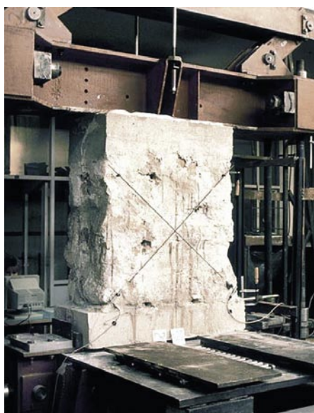
Slika 26 • Preiskava potresne odpornosti kamnitega zidu v laboratoriju
