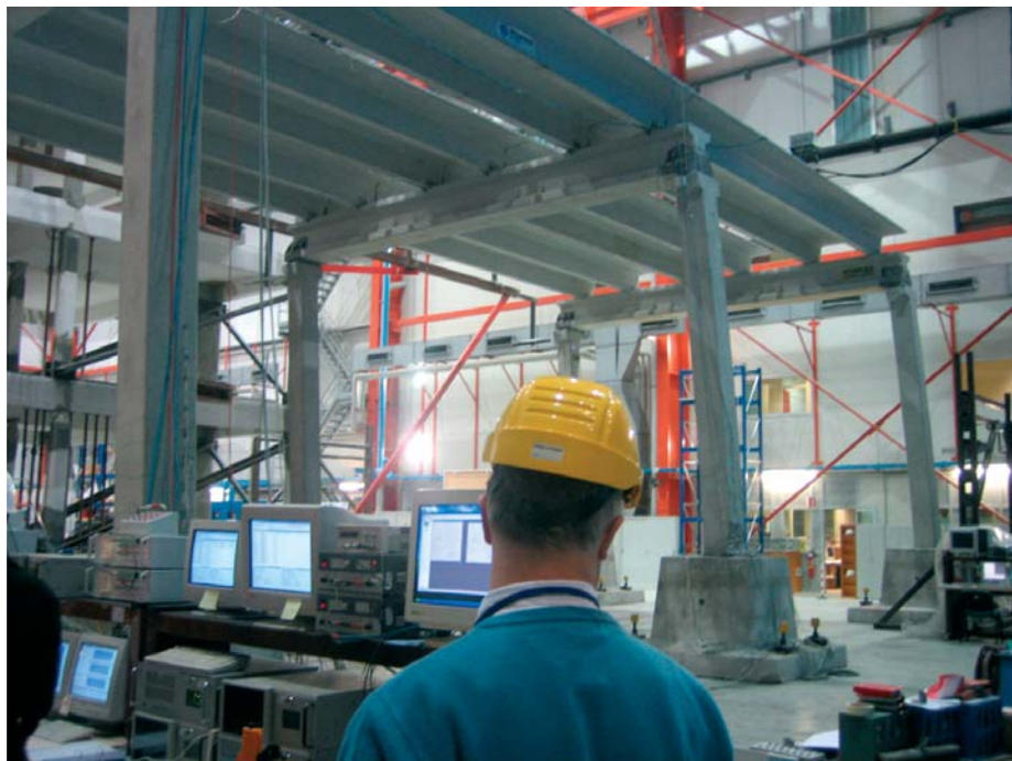
Slika 9 • Deformirana konstrukcija preizkušance 2-2 pri povprečnem zasuku za 8 %
