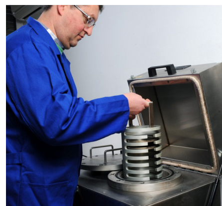
Slika 4 • PAV-postopek pospešenega staranja v komori (laboratorij ZAG Ljubljana).
