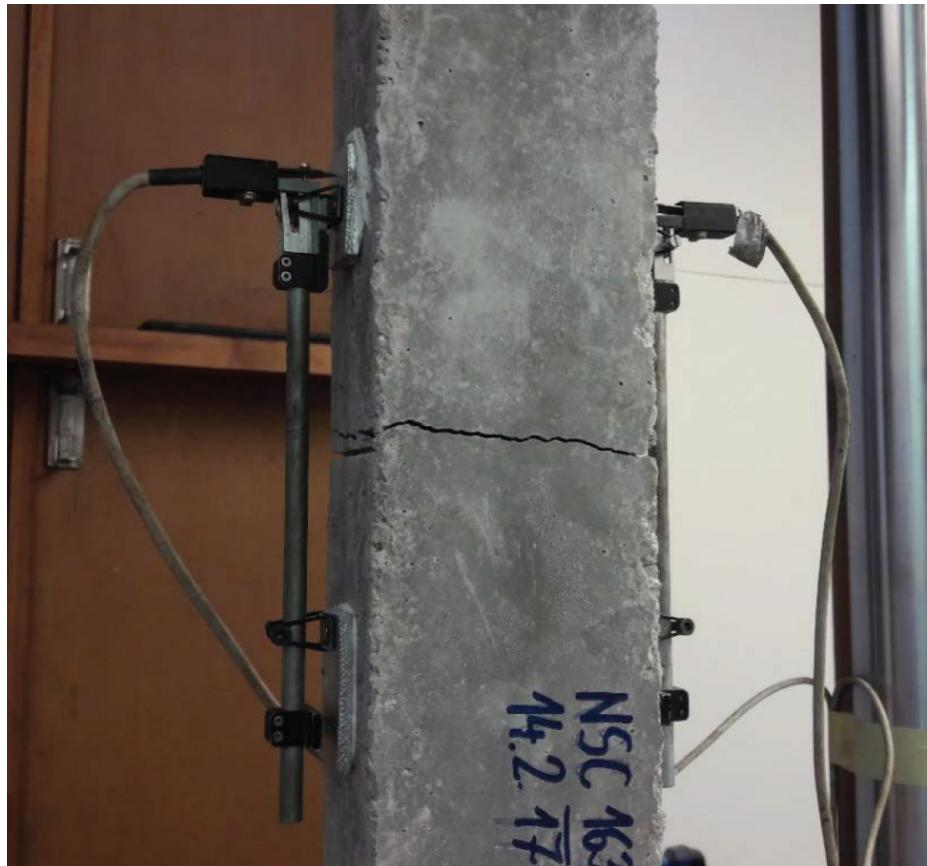
Slika 5 • Natezno obremenjeni betonski preizkušanec. Glavna natezna razpoka je pravokotna na smer natezne obremenitve (osebni arhiv).
