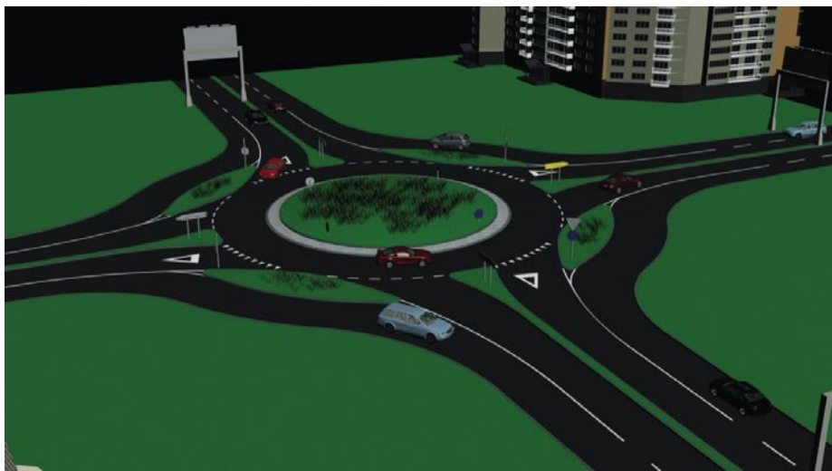
Slika 5 • Krožno križišče s pritisnjenimi pasovi za desno zavijanje – »flower roundabout«
