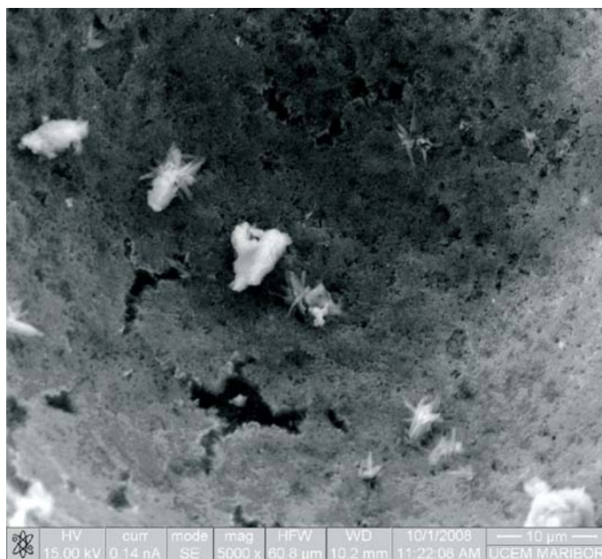
Slika 15 • Mikrostruktura preskušancev CI/DT po 121 dneh, povečana 5000-krat
