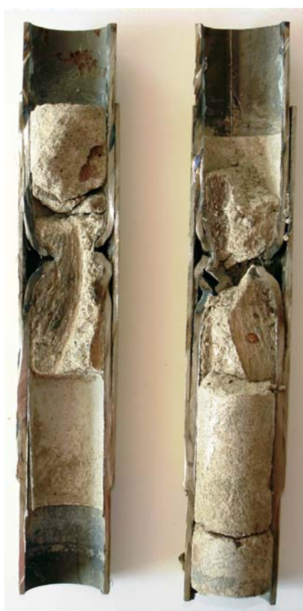
Ciklični test številka 10, amplituda pomikov u = \pm 4,0 mm
