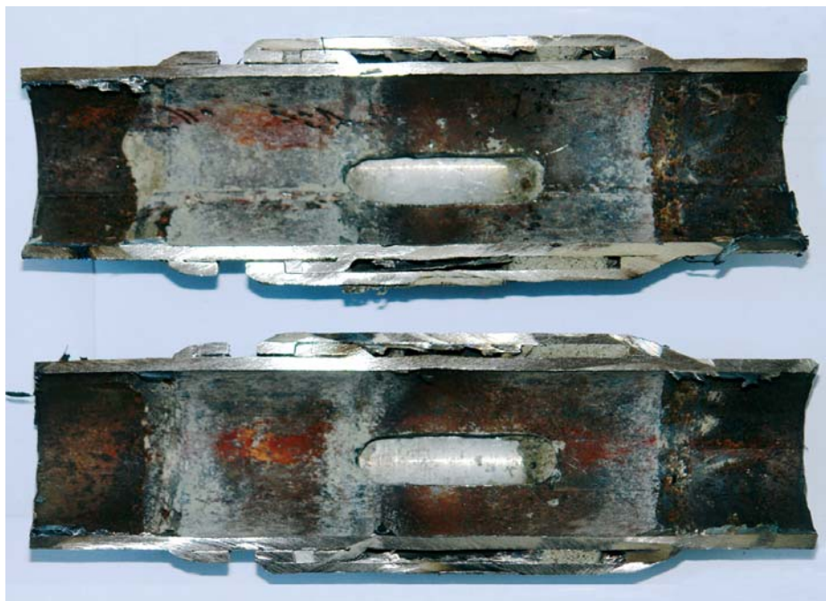
Slika 3 • Originalni dušilec, prerezan na dva dela
