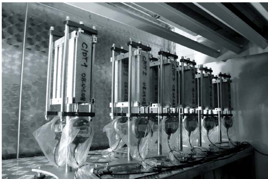
Slika 1 • Merilni komplet za merjenje ekspanzije na preskušancih v klimatski komori
