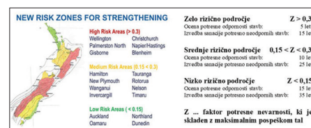
Slika 22 • Roki za utrditev potresno ogroženih stavb na Novi Zelandiji.
