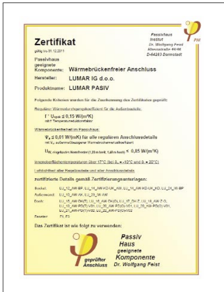
Slika 4 • Certifikat inštituta Passivhaus v Darmstadtu potrjuje, da projektirani detajli v podjetju Lumar izpolnjujejo merila pasivne hiše, podana na inštitutu Passivhaus
