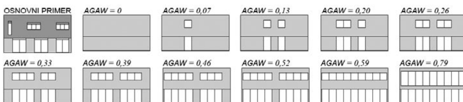
Slika 4 • Model spreminjanja deleža steklenih površin na zunanji, južno orientirani steni
