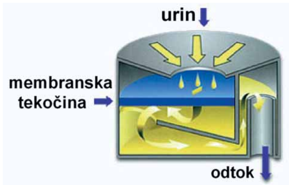
Slika 4 • Prerez skozi urinalski vložek
