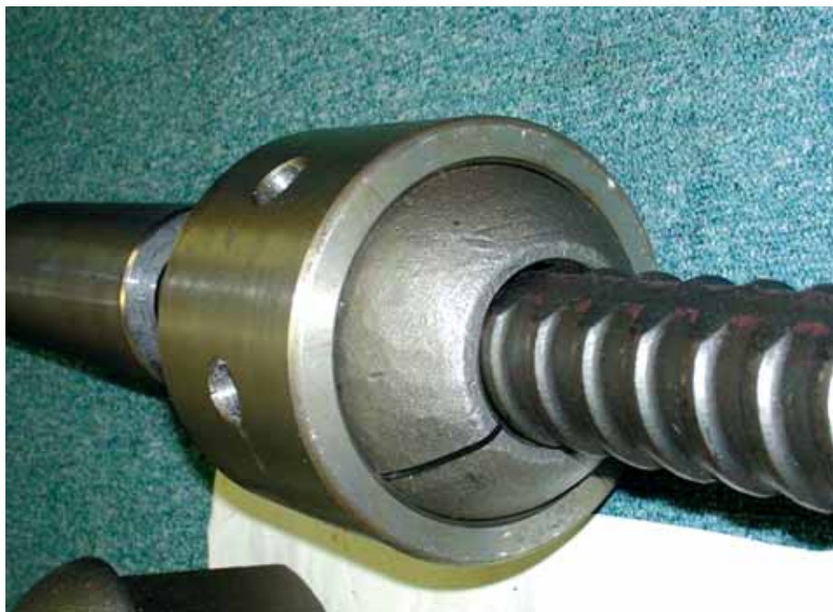
Slika 1 • Prerezana matica z objemko
