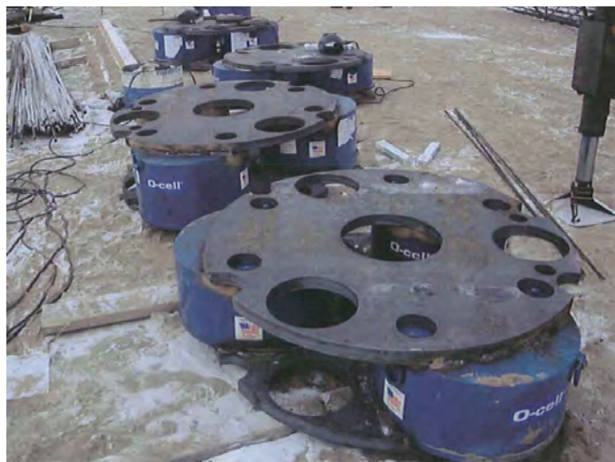
Slika 11 • Test dvigalke Osterberg Cell.
