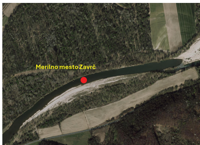
Slika 6. Zračni posnetek merilnega mesta pri Zavrču, z vidno erozijo leve brežine in akumulacijo plavin na desni strani.
