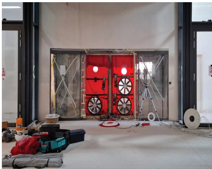
Slika 9. Julij 2024: Uspešno je bil izveden preizkus zrakotesnosti, s čimer so bili doseženi visoki okoljski standardi za javno športno stavbo tako velikega obsega. (Foto: arhiv Elea iC, d. o. o.)
