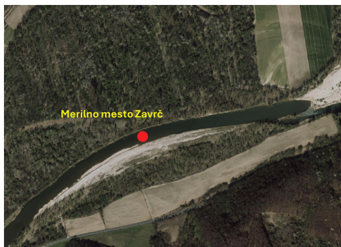
Slika 6. Zračni posnetek merilnega mesta pri Zavrchu, z vidno erozijo leve brežine in akumulacijo plavin na desni strani.
