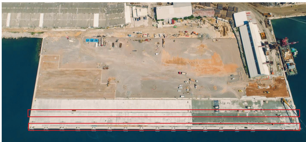
Slika 3. Območje vgradnje sider na pomolu (označeno z rdečo) in shema sidranega priveza (Foto: Lučka uprava Rijeka).
