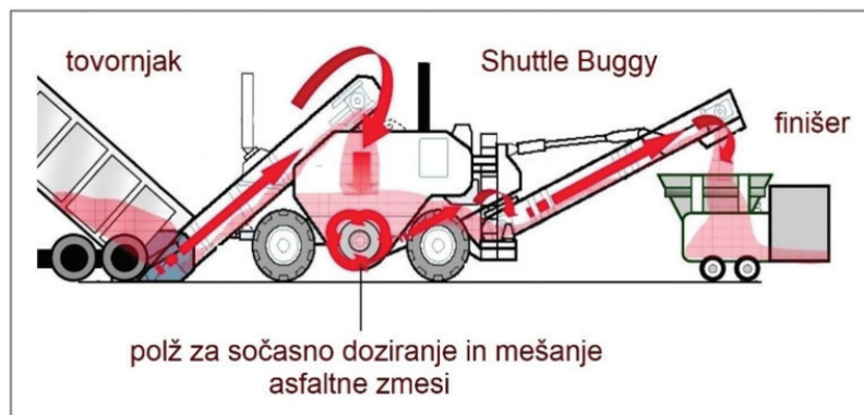
Slika 14. Podajalnik shuttle buggy [Rošar, 2020].
