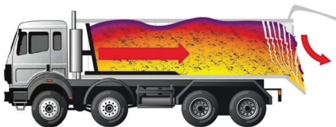
Slika 13. Keson s potisno tehnologijo (push-off) [Fliegl, 2018].
