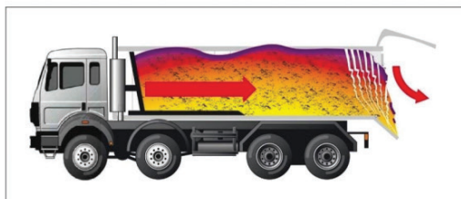
Slika 15. Ukrepi za preprečevanje temperaturne segregacije [Rošar, 2020].
