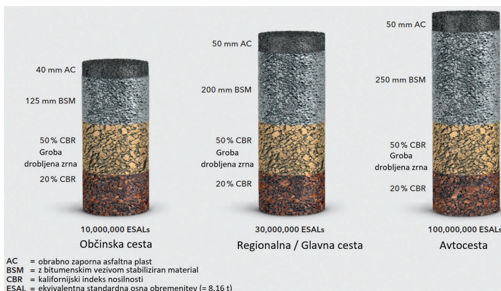
Sliki 5. Različni tipi voziščnih konstrukcij [Wirtgen, 2019b].
