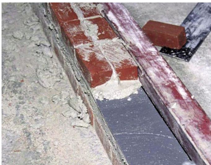
Slika 4 • Polimerna vlagozaporna folija, vložena v zidovje modela M2
