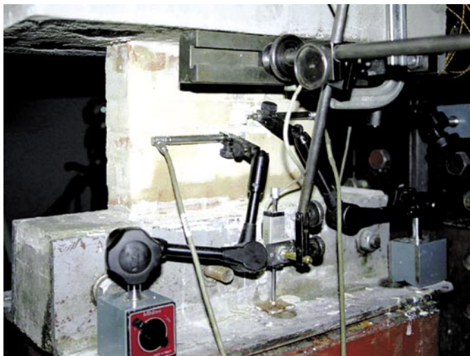
Slika 8 • Preiskava drsnih lastnosti modelnega zidu z vlagozapornim slojem
