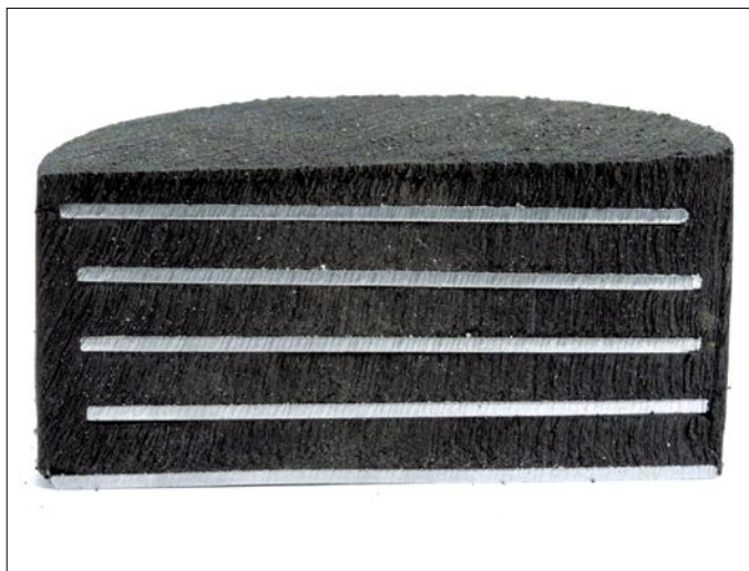
Slika 9 • Sestava potresnega izolatorja
