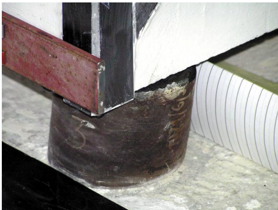
Slika 17 • Odtrgani izolator modela M5 po končani preiskavi na potresni mizi
