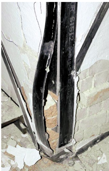
Slika 16 • Detajl iztrganja sidrišča CFRP trakov v vogalu modela M4
